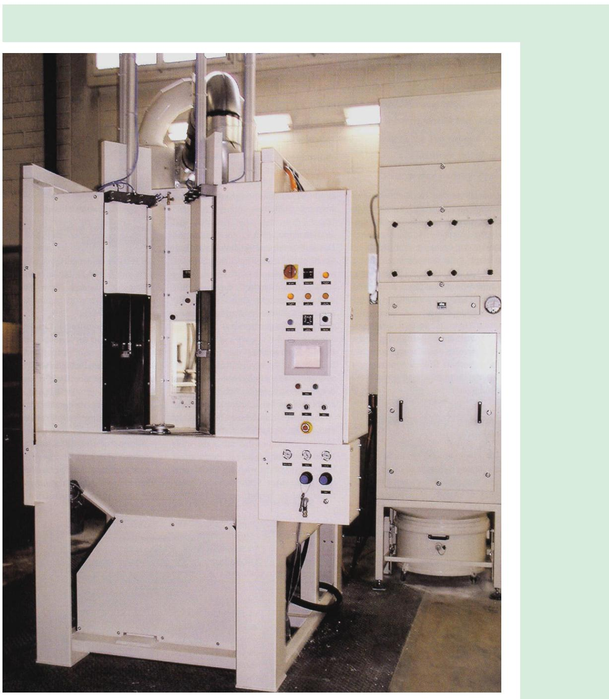
Die ***Satelliten-Drehtischchanlage «sandmaster»*** mit einer Kabinenbreite bis zu 140 cm verfügt über eine moderne SPS-Steuerung (Bild rechts). Die Anlage ist insbesondere für die Mikrostrahltechnik konzipiert. Dies ermöglicht, auch Mikrokorngrößen einwandfrei zu verarbeiten. Bei der Haftgrundvorbereitung von Hartstoffsichten setzen die Anlagen ganz neue Massstäbe
